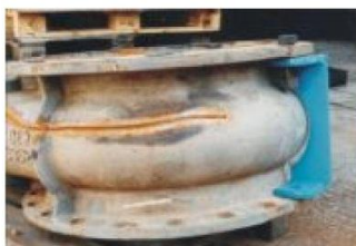
Холодная сварка корпуса насоса.
