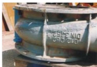
Холодная сварка корпуса насоса.
